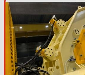
Unità di frantumazione con doppia regolazione idraulica (entrata/uscita). L'apertura e la chiusura può essere eseguita anche durante la fase di lavoro.
