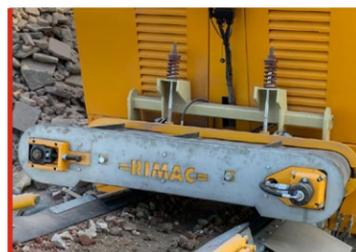
Separatore magnetico a nastro BIDIREZIONALE. Regolabile idraulicamente e con sistema di sicurezza a molle.
