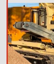
Nastro trasportatore laterale con sistema di chiusura/apertura idraulica.
