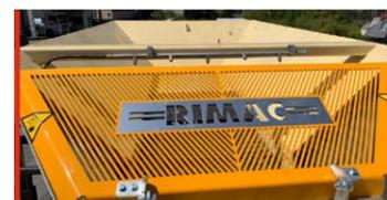
Sistema di nebulizzazione a tre zone comprensivo di serbatoio acqua a bordo macchina. Bocchetta di protezione frantoio apribile.
